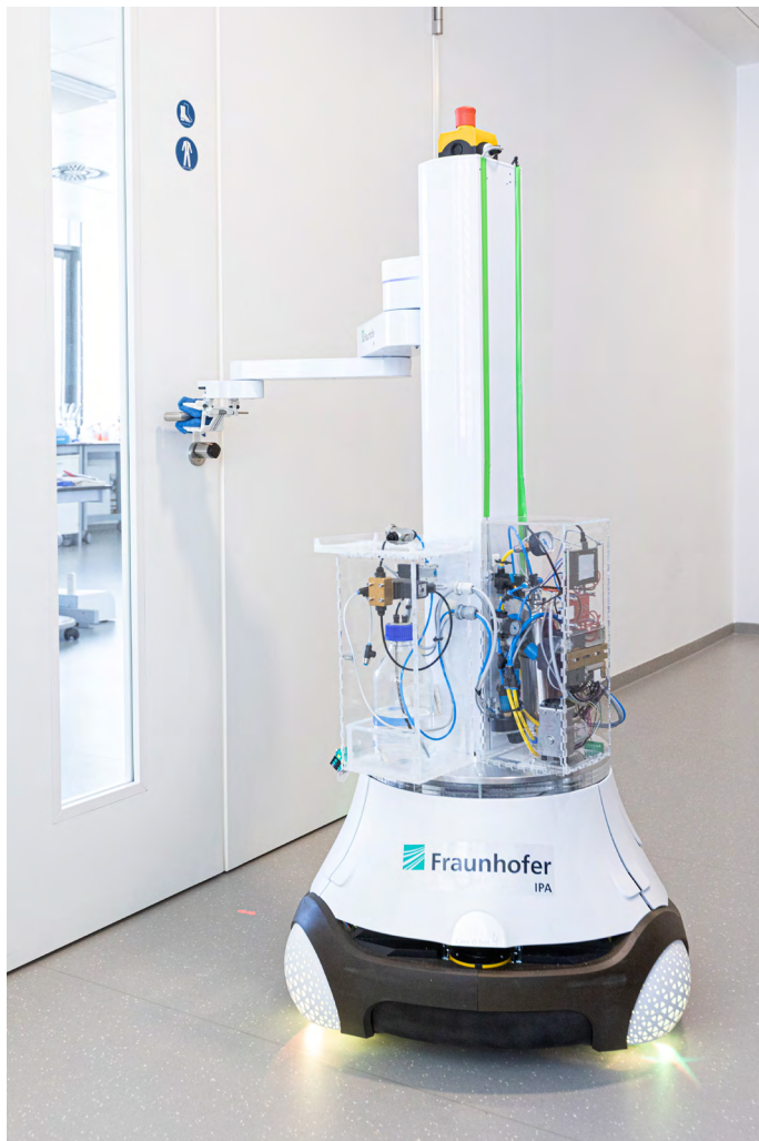
Bild 1: Der mobile Reinigungs- und Desinfektionsroboter DeKonBot fährt selbstständig zu kritischen Objekten wie Türgriffen und desinfiziert diese.
